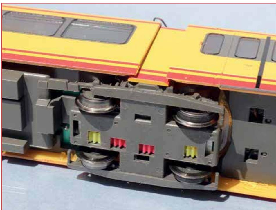
**En haut :** gros plan sur la voiture centrale du tramway, pièce maîtresse du modèle à plusieurs titres. Le moteur est logé dans cette voiture qui assure la transmission aux deux bogies moteurs placés sous les articulations entre les caisses. En toiture, cette voiture reçoit également tous les équipements électriques.
