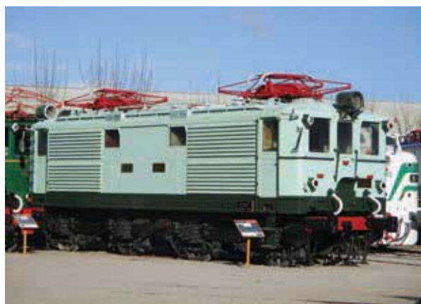
Dans l'histoire des chemins de fer espagnols, la 1004 est, dans l'effectif des locomotives électriques, la machine qui a assuré le plus long service. Commandées par l'État dans le cadre de l'électrification de la ligne « Ripoll – Puigcerdá » et construites en 1929, ces machines sont une déclinaison des E 4000 du Midi. Administrativement rattachées aux dépôts de Barcelone-Vilanova jusqu'à sa fermeture en 1981, puis Casa Antúnez, ces machines étaient généralement stationnées dans la gare de Ripoll sur leur ligne de prédilection.
