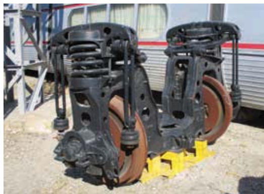
Détail de l'anneau d'intercirculation supportant les deux roues à écartement variable.
