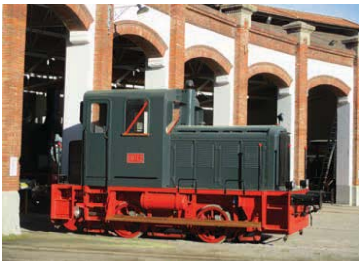
Le locotracteur 10112 fait partie d'une série de 46 locotracteurs construits entre 1949 et 1963 par l'entreprise « La Maquinista Terrestre y Marítima ». Il a été restauré et remis en état de marche au musée des chemins de fer de Madrid-Delicias en 2016 par l'entreprise « Interfer ». Il a incorporé la collection du musée de Vilanova en mars 2017 afin de disposer d'un engin pour déplacer les véhicules présentés au musée.
