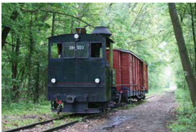
Au terminus de Hármashegyfalja, dans le parc régional, la locomotive fait le plein d'eau depuis un réservoir d'eau discrètement logé dans le wagon couvert accompagnant la rame. Le réservoir de la machine est situé entre les essieux.
