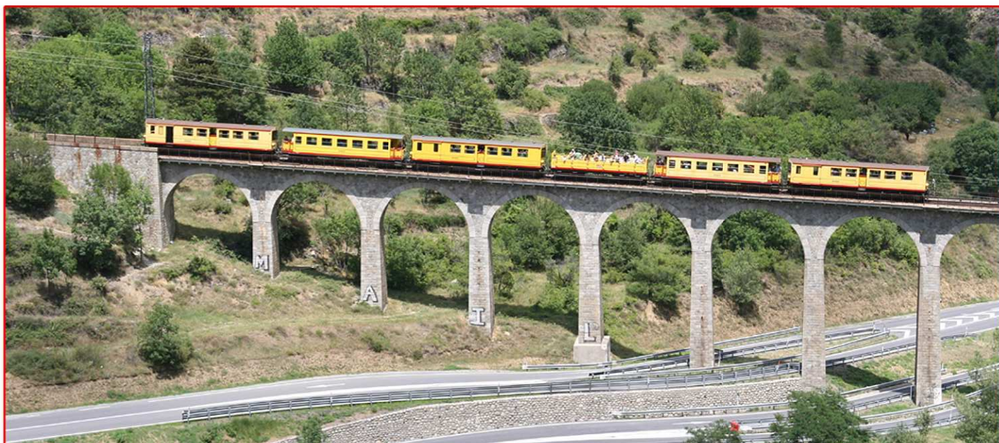
(Ci-dessus), Un Train Jaune franchit le viaduc Séjourné. Il est composé de six éléments; la composition maximale de la ligne. Photo: Guillaume Pourageaux (Juillet 2006)
