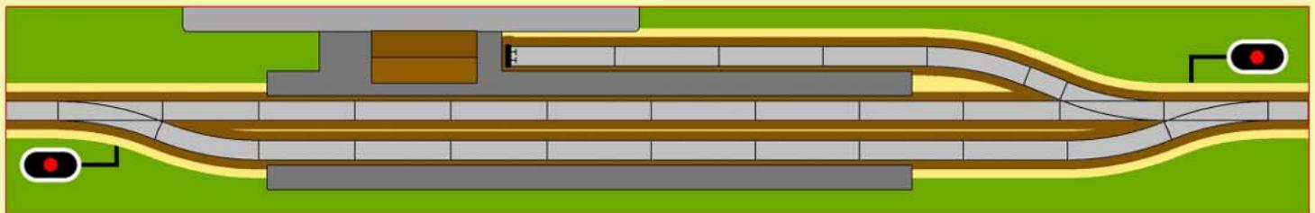
Sur le réseau ferroviaire français, le sémaphore en voie unique est équipé d'un feu rouge et d'un feu vert. Le signal est commun aux deux voies de la gare et son rôle est de protéger le canton.
